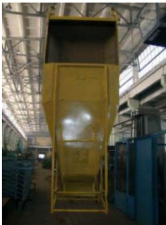
**Ящики для бетона предназначены для приема и транспортировки бетонной смеси к месту бетонирования конструкций на строительных площадках**
